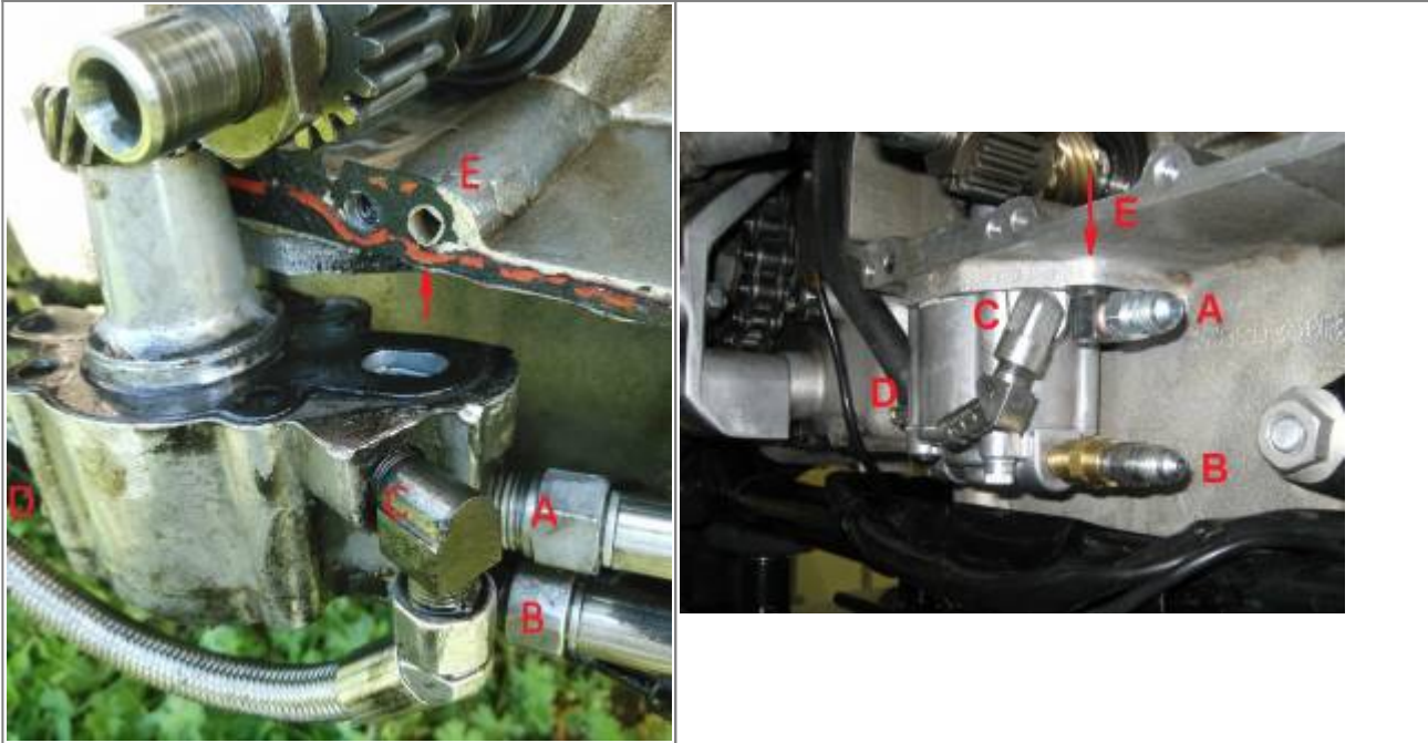
86-90 pump fitting locations 22) 23)
