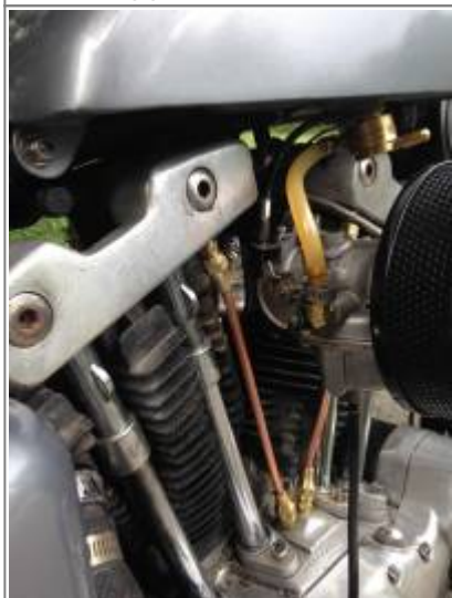
Copper Oil Lines 46)
