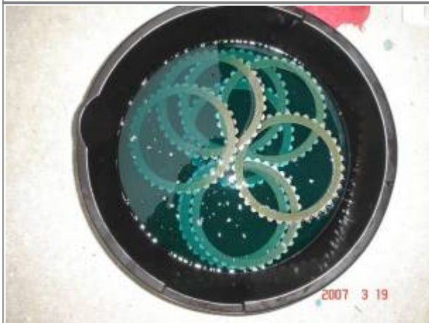
Soaking fiber clutch discs 18) 19)
