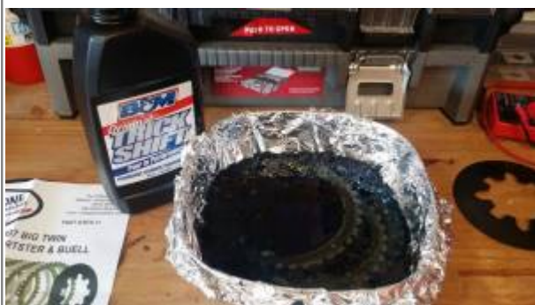
Soaking fiber clutch discs 18) 19)
