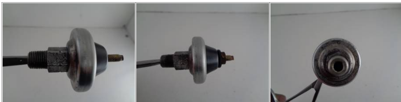
Oil pressure switch (26554-77) 56)
